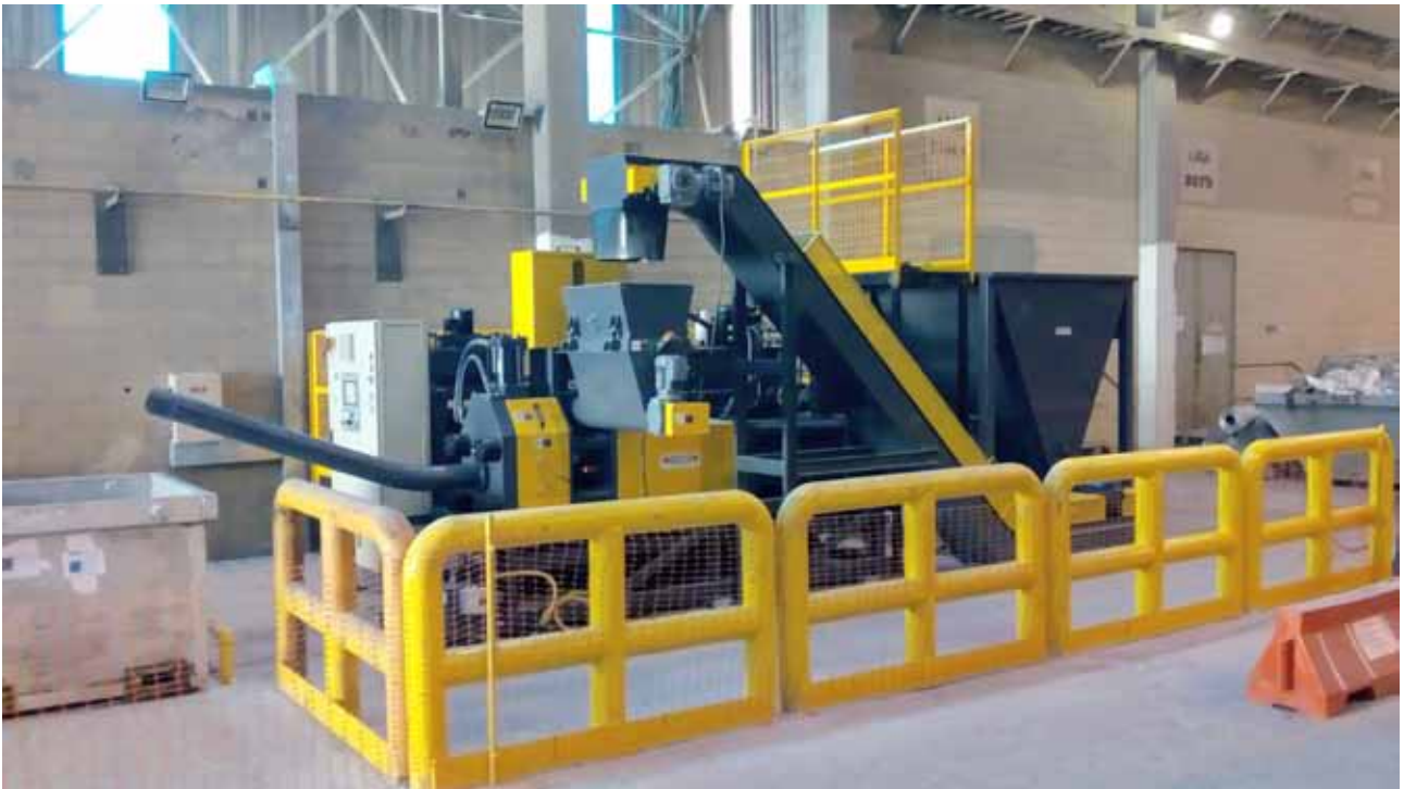
Equipamentos: Briquetadeira PBH-S-300T com Silo Alimentador, Esteira e Kit de Bombeamento Material: Cavacos de Alumínio com Óleo de Corte Cliente: CIA. BRASILEIRA DE ALUMÍNIO (CBA) - Unidade de Caster 7 a 12 Local: Alumínio - SP
