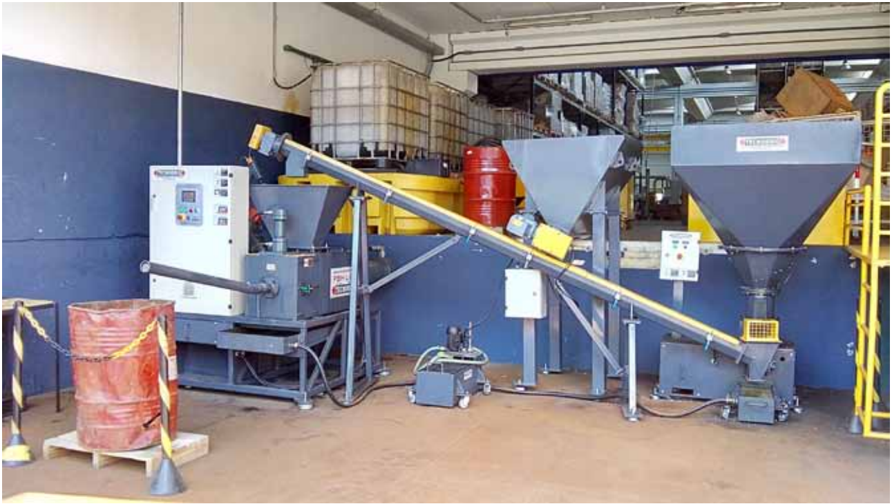
Equipamentos: Briquetadeira PBH-L-85T com Triturador, Silo, Rosca Alimentadora e Kit de Bombeamento Material: Cavacos de Ferro Fundido, Bronze e Alumínio com Óleo de Corte Cliente: FRANKLIN ELECTRIC ( BOMBAS SCHNEIDER ) Local: Joinville - SC
